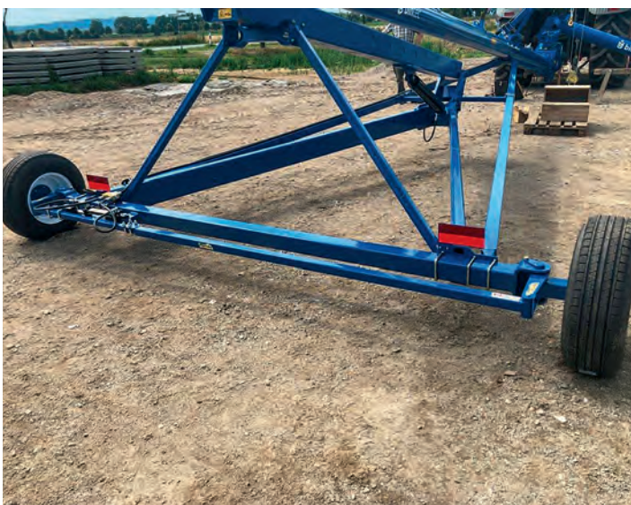
Zapfwellengetriebene Getreideschnecke mit SwingAway-Annahme als optimales Bindeglied zwischen Erntelogistik und Lager.
